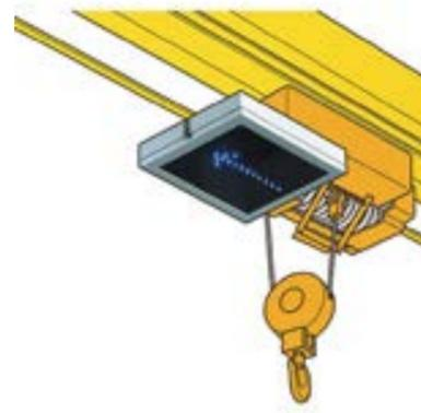
表示機による操作方向の見える化
