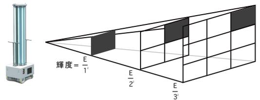
紫外線 UV-C (波長 254nm) の効果は菌の種類や生息条件によって異なりますが、さまざまな菌種に対して有効であると言われています。また、それぞれの菌についての効果は、殺菌線量すなわち、殺菌線照度 (W/m<sup>2</sup>) × 照射時間 (秒) によって表すことができます。したがって、一般的に照射時間を 2 倍にすれば殺菌線照度を 1/2 にしても同じ効果が得られます。
